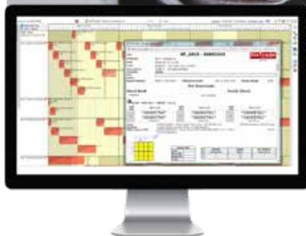
O planeamento serve-se desta configuração para fazer as sequências das operações e definir a percentagem de conclusão de uma operação para que se possa iniciar a seguinte operação. No planeamento da produção é possível ajustar a percentagem de conclusão de operação através da opção “percentagem de operação anterior”.
